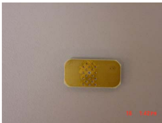
图 10 焊接测试板的背部情况
