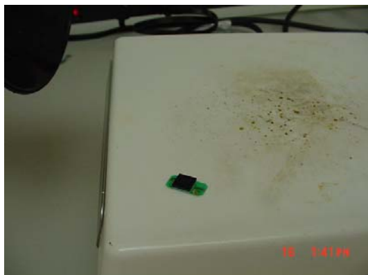
图 8 在偏离中心部位对模块进行预热
